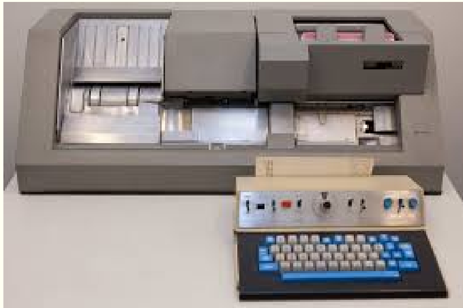
Figura 2.3: Perfuradora de Cartões IBM-029
